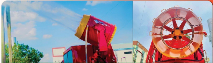
HỆ THỐNG PHUN NƯỚC CỨU HÒA • Hệ thống vòi phun tia ( phun mưa) ở khoảng cách 40-70m với lưu lượng 2800-3000l/ph. Tạo vùng bảo vệ nhiệt độ thấp và khi tưới cho người lính chữa cháy tiếp cận hiện trường. • Hệ thống vòi nước có thể phun sương mịn dập khói bụi ở lưu lượng 1000 l/ph tại áp suất 7 bar.
