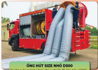
ỐNG HÚT SIZE NHỎ D500 Đường ống hút khói chịu nhiệt độ lên tới 400°C, chống cháy. Chiều dài đường ống từ 10-30m
