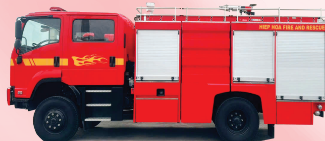
Xe chữa cháy 2 cầu loại 4x4 3.000L nước + 300L bột
