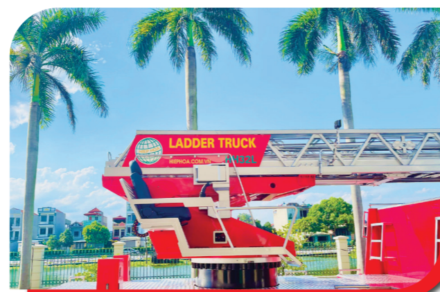
Trạm điều khiển chính trên bộ quay thang
