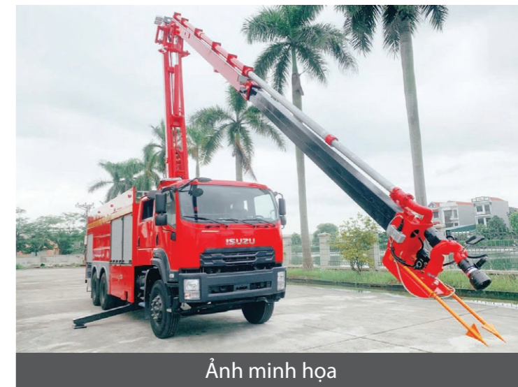
5. Xe chữa cháy – loại có cần vươn điều khiển từ xa chiều cao 21,5m
